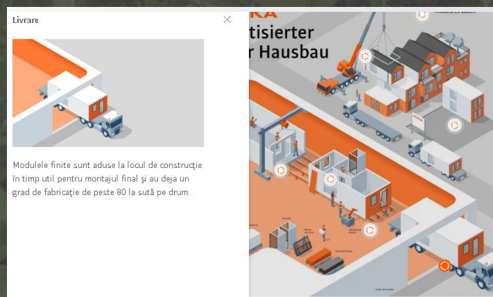
Fig. 8 - Livrarea modulelor finite din fabrica viitorului KUKA
