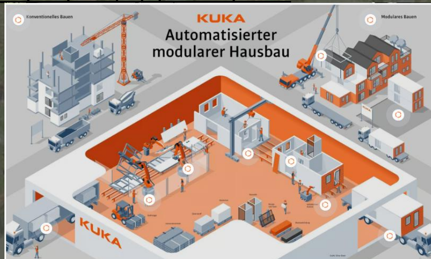
Fig. 1 - Fabrica viitorului KUKA, unde robotii intervin in procesele de constructie modulară
