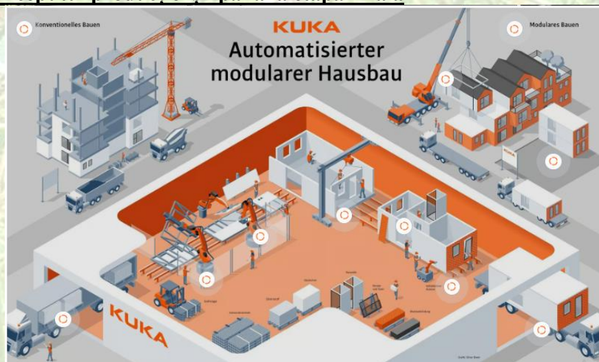
Fig. 1 - Fabrica viitorului KUKA, unde roboții intervin în procesele de construcție modulară
